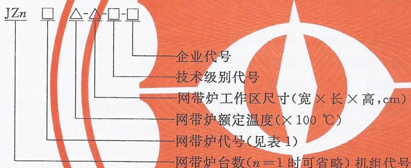
示例：企业代号为 FL 的企业所生产的由一台额定温度 700 °C、工作区尺寸(宽×长×高, mm): 400×2 500×200 的无炉罐贯通式，控制气氛网带炉所组成的回火加热机组型号为：
