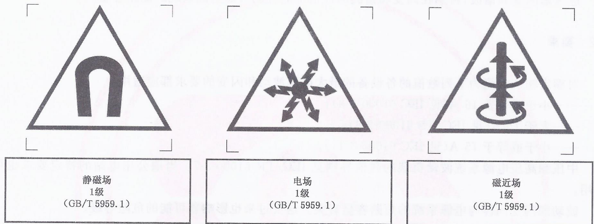
图 F.1 磁场和电场的标记示例
